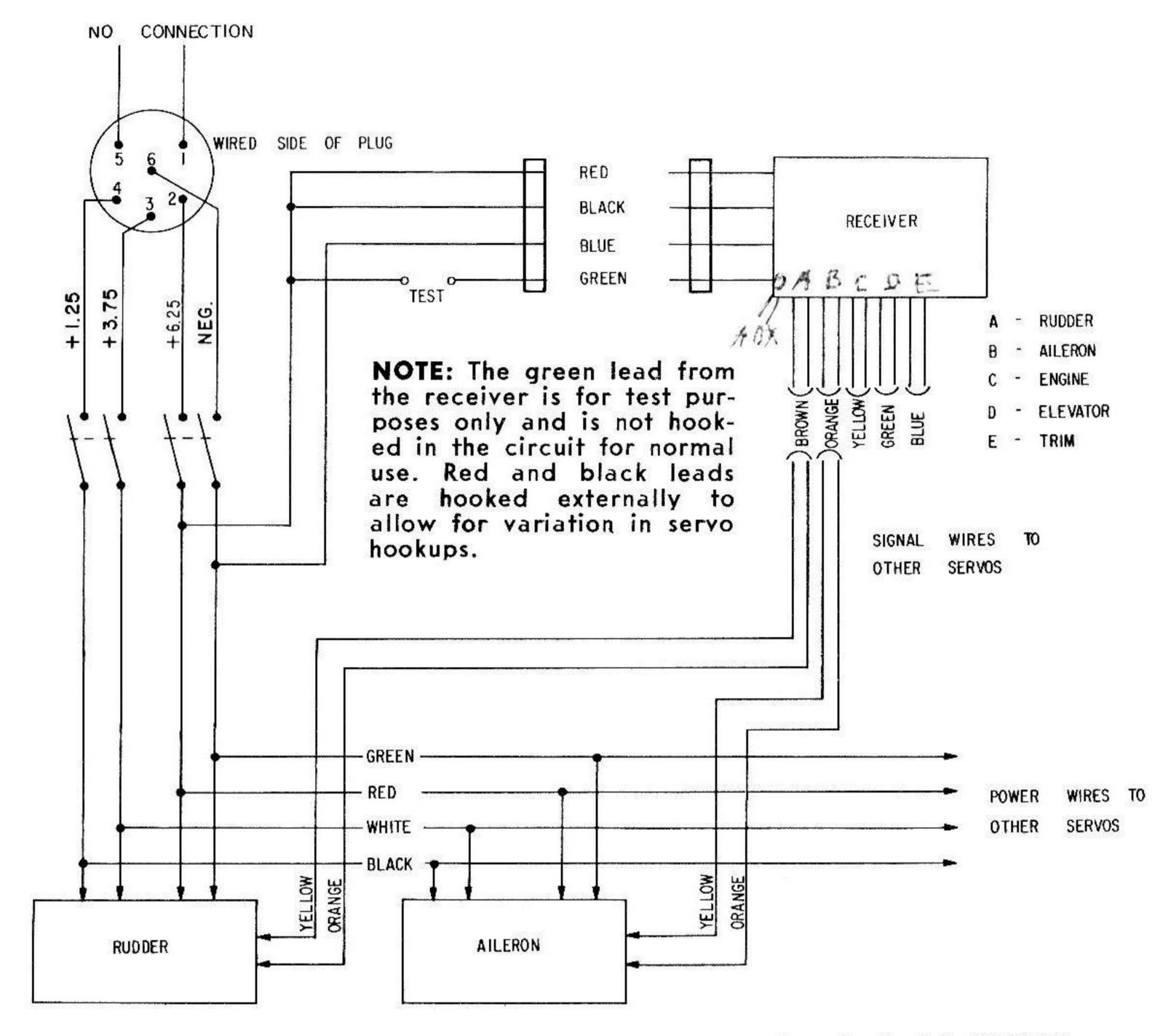
WIRING DIAGRAM FOR OLD STYLE PLUG & SOCKET 5B30 & 5500 PACK
