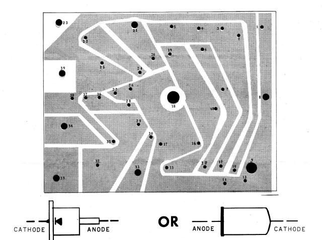
THE INSULLATED END OF THE DIODES IS THE ANODE
